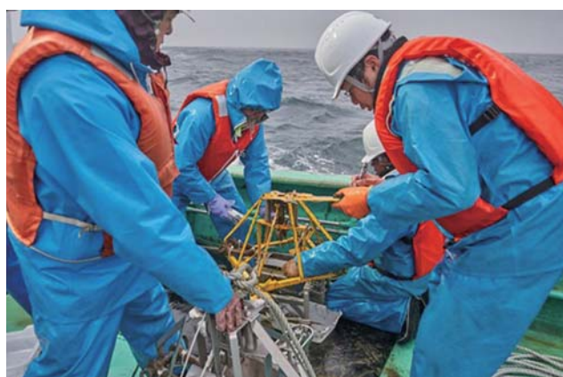
図4 底質の採取（2020年1月北部海域）試料採取の前に表面線量率を測定します。
