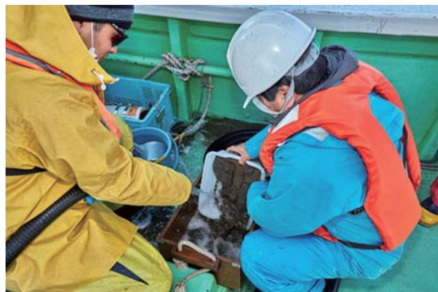
図7 マクロベントスの採集（2019年1月中部海域） 採泥器で底質を採取後、目合い0.5 mmの篩でふるい、篩上に残ったものを試料とします。
