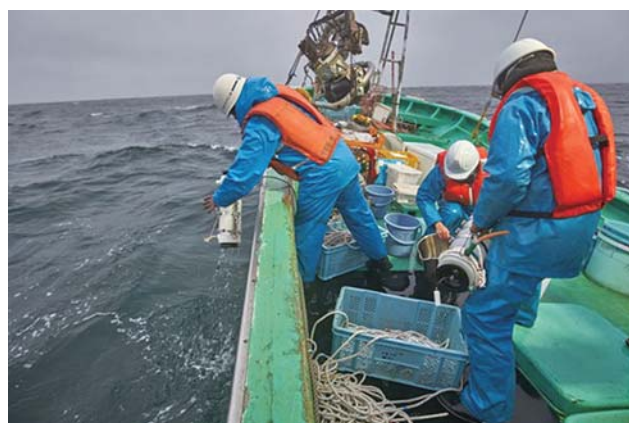
図3 表層水（海面下0.5m）及び底層水（海底直上1m）の採水（2020年1月北部海域）
